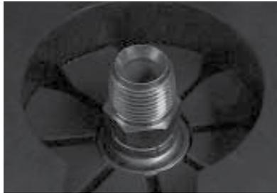
4. Extraiga la conexión y cheque el diámetro de crimpado, que debe medir 1.000"  $\pm$  0.003".
