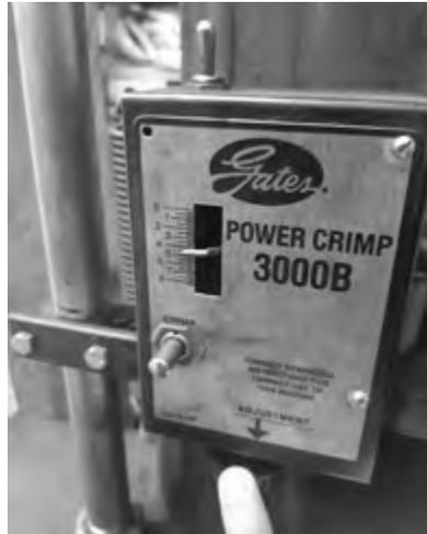
4. Para validar la Calibración del equipo, colocar la aguja del switch box en la posición de  $2\frac{1}{4}$  y utilizar una manguera G2 con el dado 33 y conexión 8G (MegaCrimp®). Una vez ensamblada, extraiga la conexión y cheque el diámetro de crimpado, el cuál debe medir  $1.000" \pm 0.005"$ .
