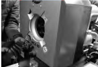
27. Colocar tapa del micrómetro (Imagen 74).
