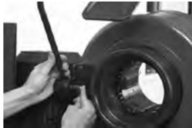
10. Posteriormente se coloca el panel de control en una posición más confortable para el operador; éste puede girar su posición con la ayuda de una manija localizada a la izquierda del panel. Al aflojar la manija se podrá girar el tablero, siendo su rango menor a 90 grados (Imagen 9).
