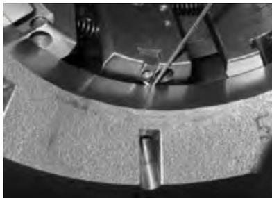
20. Asegurarse de que las tuercas estén montadas paralelamente a la ranura.
