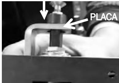
6. Una vez hecho esto, colocar de nuevo el contador en la parte de bronce del tornillo sinfín y apretar el opresor que los une, manteniendo el contador en la digitación a "9940", manteniendo el tornillo sinfín en su posición de retracción total (Imagen 9).
