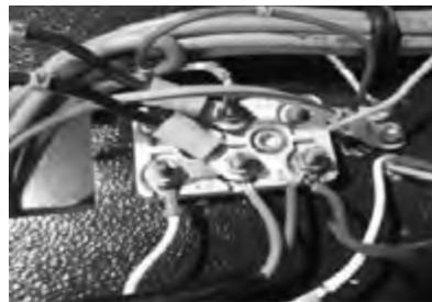
6. Con el desarmador de cruz abrir la abrazadera y liberar el capacitor (Imagen 20).
